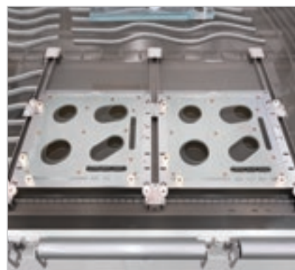
Possibilité de positionner plusieurs gabarits sur le plan de travail pour augmenter la productivité.
